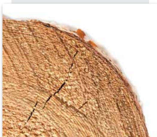
Il pino nordico si presenta con una corteccia superficiale di ridotto spessore, con le linee di accrescimento sottili ed uniformi e con una elevata uniformità cromatica, prova di crescita omogenea e controllata. Le fessure presenti sono una componente naturale del legno.
